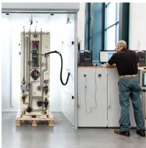
Elke multifunctionele boiler wordt elektrisch en hydraulisch getest vóór de uitlevering.
